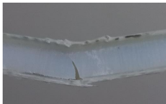
شکل ۴- نمونه سازه ساندویچی بعد از شکست.
