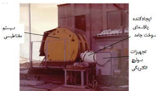
شکل (۶): پالس ژنراتور استفاده‌شده در تیان شان [۷].
