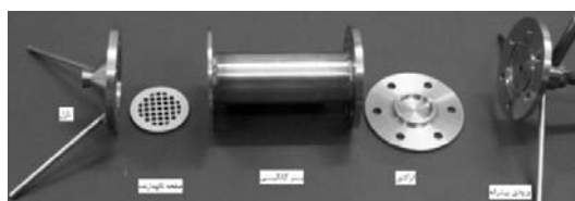
شکل (۱۴): شماتیک یک تراستر هیدروژن پراکساید [۳۵].
