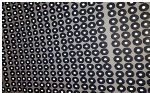
شکل (۸): نقاط هدف بازتابنده نور، آماده جهت نصب بر صفحات تست فیلد.
