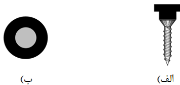
شکل (۱۰): ساختار فنی نقاط نشانه جهت تعریف مقیاس: الف) دید جانبی و ب) دید فوقانی.
