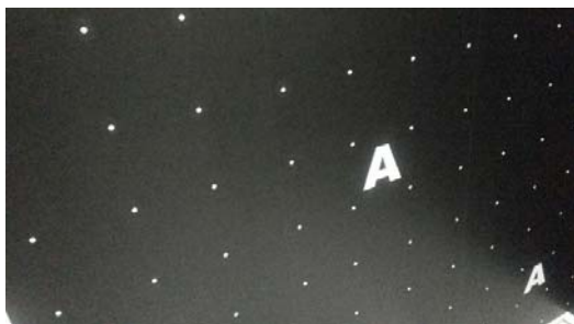
شکل (۶): نصب نقاط بازتابنده بر روی صفحات و نشانه‌گذاری آنها با علائم و حروف.
