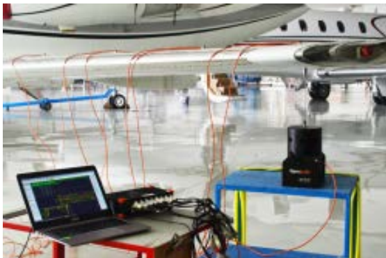
شکل (۱۳): اندازه‌گیری در آزمون ارتعاشات زمینی هواپیما [۴].
