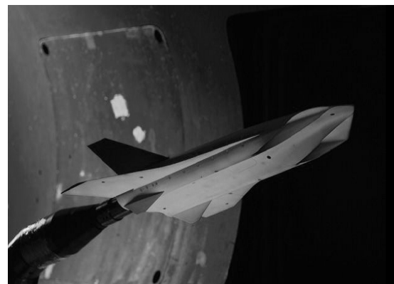
شکل ۴- آزمایش آیرودینامیک و آیروترمال یک وسیله کروز ماورای صوت در قالب برنامه «آزمایش پرواز ماورای صوت بین‌المللی»
