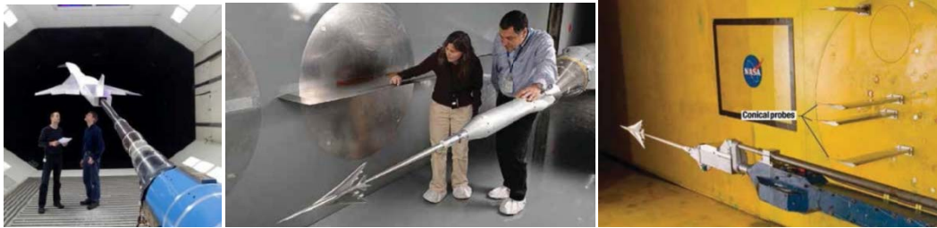
شکل ۵- برخی از آزمایش‌های تونل باد انجام شده بر روی مدل‌های ساخته شده بر اساس طراحی‌ها [۴، ۵]
