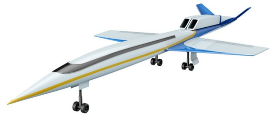
شکل ۱۰- طراحی اولیه SSBJ شرکت هوافضای اسپایک [۱۴]
