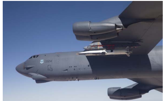
شکل ۳- بمب افکن B-52 و موشک پگاسوس استفاده شده برای آزمایش موتور اسکرمجت ناسا [۱].
