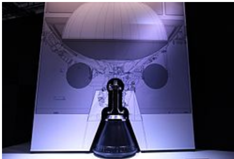
شکل ۱۰- موتور موشکی وینچی [۱۹].
