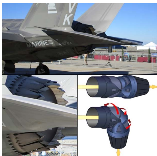
شکل ۱- سیستم مکانیزم مکانیکی نازل مورد استفاده در جنگنده F-35 [۱].
