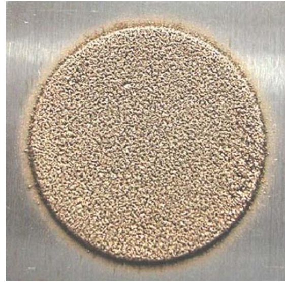
شکل (۲): قطعه نمونه به همراه لایه رسوبی تشکیل شده بر روی سطح [۲].
