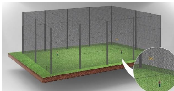
شکل (۶): تصویر شماتیک اتاقک تست پهپاد.
