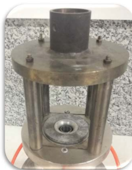
شکل (۴): محفظه احتراق SGTMC و نازل‌های ورودی هوا و سوخت به آن [۲]
