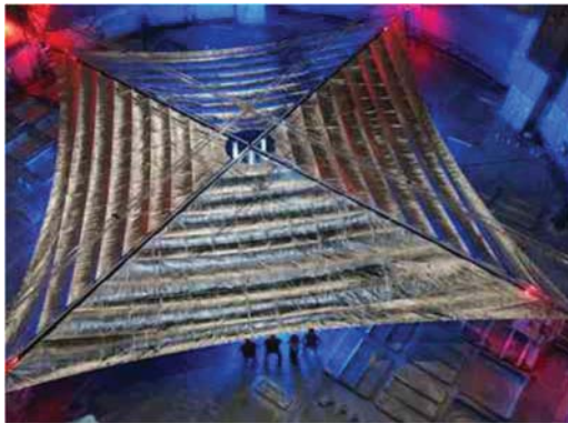
شکل (۹): برگ درختی که الگوی میورا-اوری از آن گرفته شد (بالا) و بادبان آماده جمع شدن مطابق این الگو (پایین).
