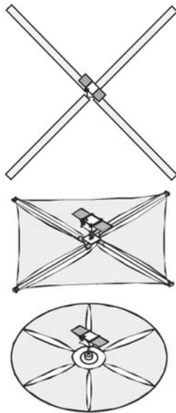
شکل (۷): ساختار مربعی و دایروی بادبان کاهش مدار.
