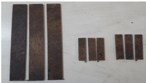
شکل (۳): نمونه آزمون خمش، نمونه آزمون ضربه و نمونه آزمون کشش (به ترتیب از راست به چپ).
