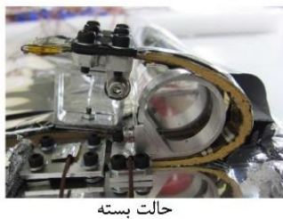
شکل (۶): ساختار رادیاتور باز شونده در دو حالت باز و بسته [۱۱].
