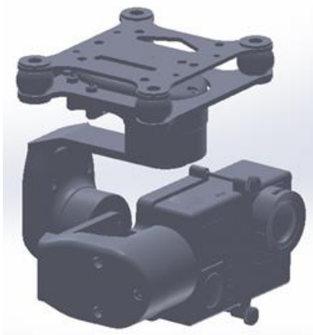
شکل (۸): دوربین و لنز لقه ۳ محوره ربات پرنده فانتوم ۳ اس ای.
