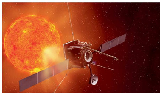
شکل (۱): ماهواره‌ها در معرض محیط‌های با اختلاف درجه حرارت بسیار متفاوت بر اساس قرار گیری در برابر خورشید یا پشت به آن [۳].
