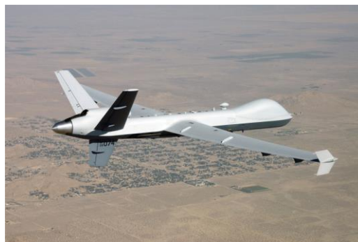
شکل (۱): پهپاد بال ثابت MQ-9 [۱].
