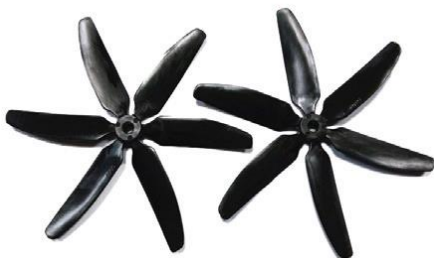
شکل (۱۵): پروانه‌های شش تیغه‌ای برای یک پهپاد [۲۸].
