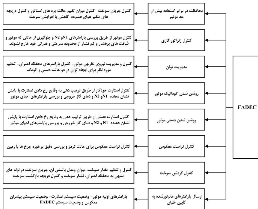
شکل (۸): دسته بندی وظایف سیستم FADEC موتور CFM56. [Error! Bookmark not defined.]
