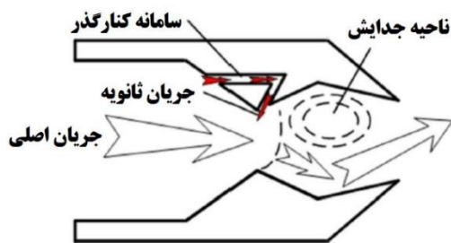
شکل ۱- نمای از BDTN و چگونگی عملکرد کانال کنارگذر [6]
