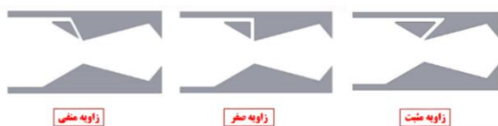
شکل ۸- شماتیک زاویه تزریق جریان ثانویه
