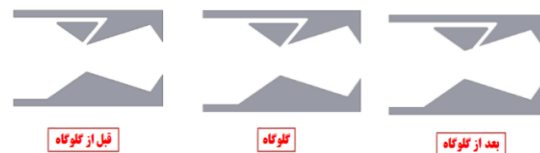
شکل ۶- شماتیک موقعیت محوری تزریق جریان ثانویه
