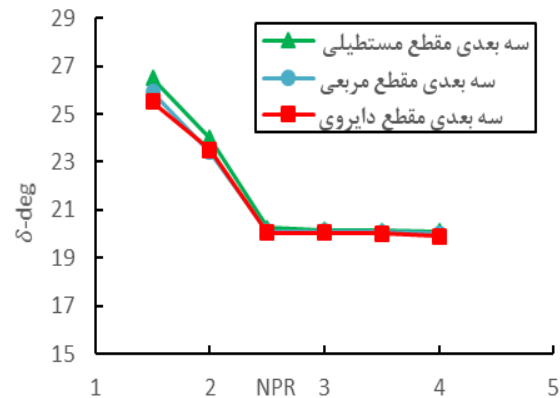
شکل ۱۳- تغییرات زاویه انحراف بردار تراست برای حالت‌های مختلف شکل سطح مقطع جریان ثانویه در نسبت فشارهای متفاوت
