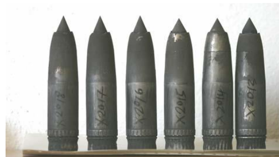
شکل ۲۲- نمونه‌های تست شده گلوله رمجت [۱۸]
