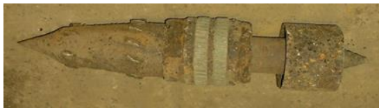
شکل ۱۳- بقایای گلوله تست شده با استفاده از تکنولوژی رمجت توسط ترومسدورف [۱۳]
