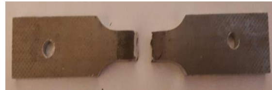
شکل ۱۶- نمونه آزمون خستگی کم‌چرخه پس از شکست
