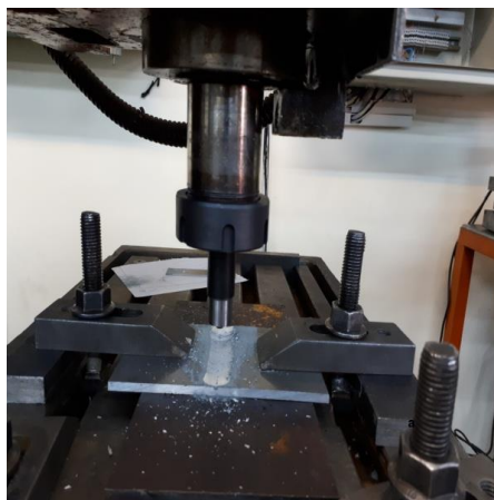
شکل ۳- ایجاد لایه سطحی کامپوزیتی به روش فرآیند اصطکاکی اغتشاشی
