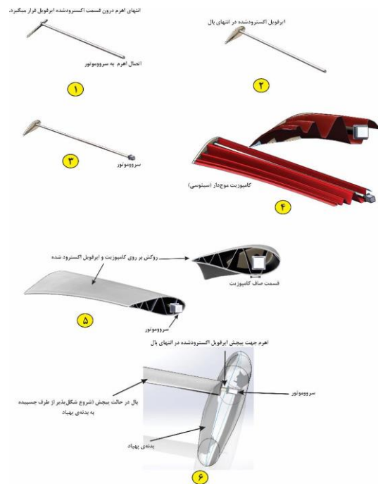
شکل ۴- نحوه تولید یک نمونه بال شکل‌پذیر در حالت پیچش بال
