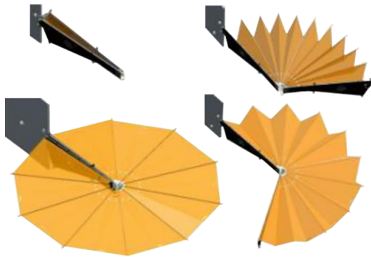
شکل ۱۲- آرایه خورشیدی UltraFlex در حال استقرار [۲۱]
