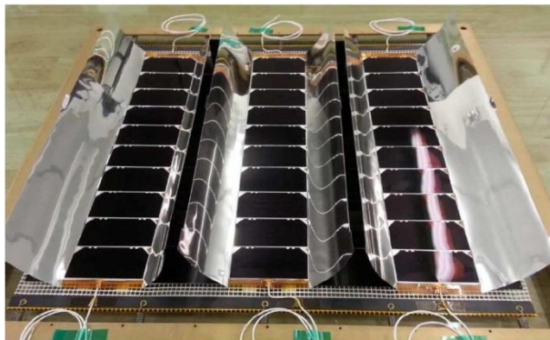
شکل ۲۴-رایه خورشیدی انعطاف پذیر متمرکز کننده FACT [۴۷]
