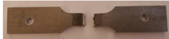
شکل ۱۵- نمونه آزمون خستگی کم‌چرخه پس از شکست
