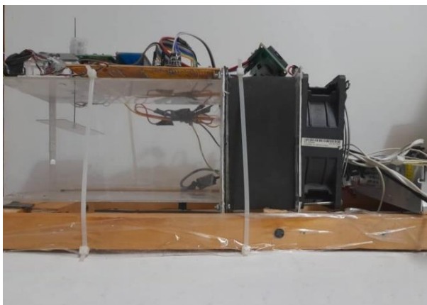
شکل ۳- صفحه تخت در تونل باد مینیاتوری
