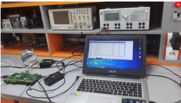
شکل ۱۰ - بستر تست و صحنه‌سنجی توسط آنالایزر CAN
