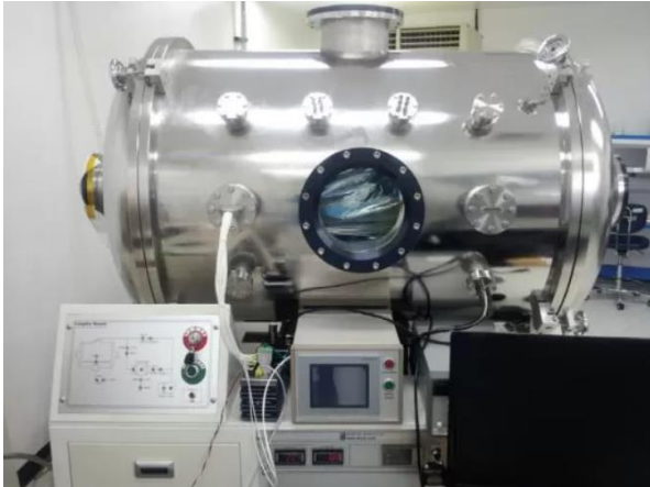
شکل ۲۶- اتاقک خلأ حرارتی برای آزمایش محیطی شرکت آریا سرمایش [۴۵]
