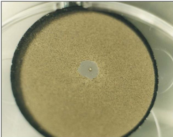
شکل ۱۲ - برخورد میکروشهاب سنگ یا بقایای مداری بر پوشش Tiodize با قطر ۲/۵۴ سانتی متر روی تیتانیوم منجر به یک شکاف با عمق ۰/۶ میلی متر و قطر تقریباً ۳ میلی متر (از بین رفتن پوشش) شده‌است [۷]
