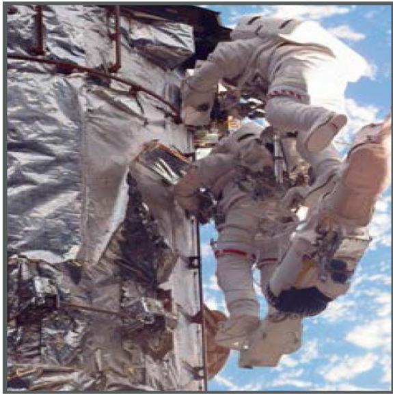
شکل ۳- شکاف‌های بزرگ ناشی از تشعشع در لایه بیرونی عایق چند لایه تلسکوپ هابل پس از ۶۸ سال قرار گرفتن در فضا [۱۵]
