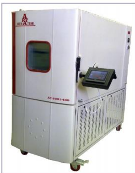
شکل ۲۴- دستگاه چمبر دما، آزمایشگاه قابلیت اطمینان و پایش سلامت پژوهشگاه هوافضا [۴۳].
