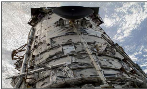
شکل ۴- تخریب شدید عایق چند لایه بیرونی تفلون-آلومینیومی تلسکوپ هابل پس از ۱۹ سال قرار گرفتن در فضا [۱۶]
