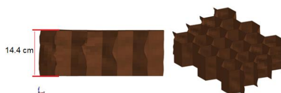
شکل ۳۱- تغییر شکل نهایی لانه زنبوری آلومینیومی
