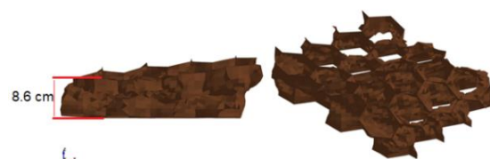
شکل ۳۲- تغییر شکل نهایی لانه زنبوری UPVC
