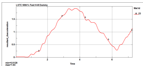
شکل ۱۶- شتاب وارده به ستون فقرات در مدل با جاذب لانه‌زنبوری آلومینیومی
