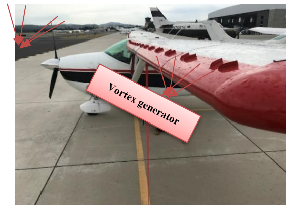
شکل ۵- مولد گرداب موجود روی بال هواپیما
