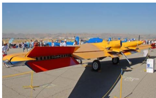
شکل ۱۲- نمای از اسپلیت درگ رادار
