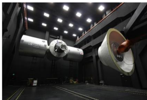
شکل ۲- نمونه بستر آزمایشگاهی بر پایه بازوی رباتیک (شبیه ساز عملیات فضایی لاکهید مارتین) [۱]
