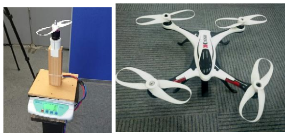
شکل ۲- نمونه‌ی ساخته شده و تحت آزمون پروانه حلقوی شیما و همکاران [۸]
