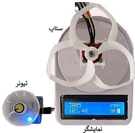
شکل ۷- پروانه حلقوی بر روی موتور، تیونر کنترلر موتور و نمایش داده بر روی صفحه نمایشگر (تصویر شماتیک)
