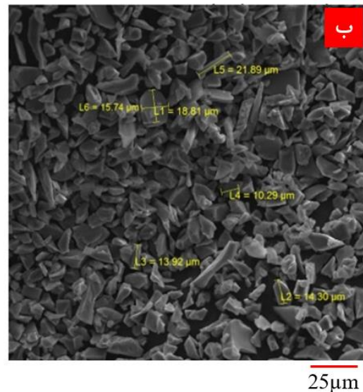
شکل ۱- تصاویر FESEM از ذرات الف) \text{CaCO}_3 ، ب) SiC و ج) \text{Al}_2\text{O}_3
