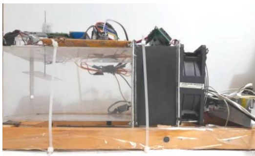
شکل ۴ - نحوه قرارگیری صفحه تخت در تونل باد.
