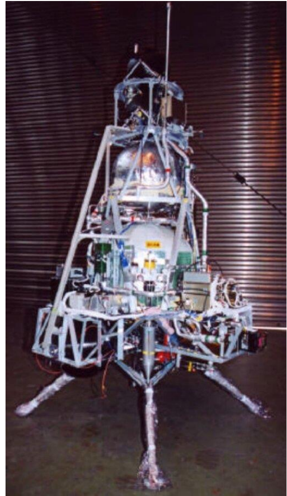
شکل ۱۲- مخزن هیدروژن مایع نصب شده بر پرتابگر RVT [۴۸].
