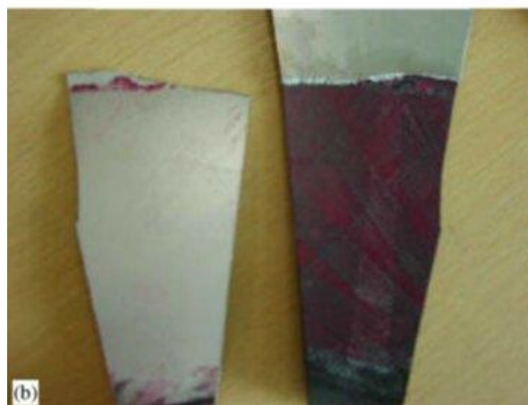
شکل ۱۱- لایه لایه شدن اتصال لاینر و CFRP [۴۸].
