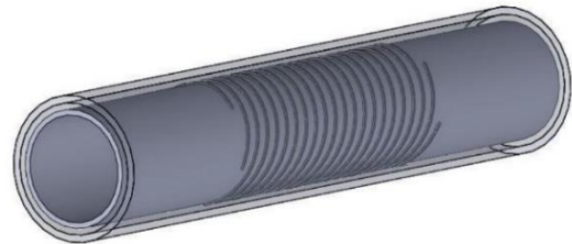
شکل ۳- لوله متحدالمرکز با تربولاتورهای مارپیچی.
