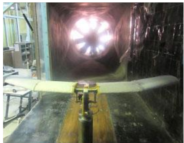
شکل ۵- نصب مدل در محفظه آزمون تونل باد آزمایشگاه تحقیقاتی دانا.
