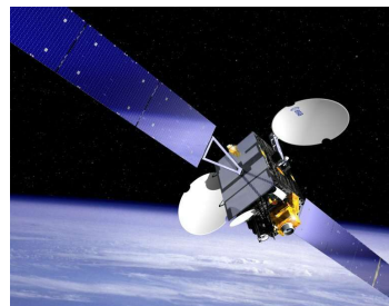
شکل ۶- نمونه‌ای از یک ماهواره انعطاف‌پذیر با آرایه‌های خورشیدی و بازتابنده‌های مخابراتی [۲۶].
