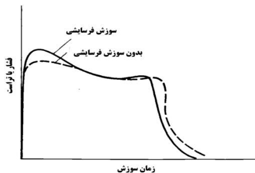
شکل ۴- منحنی فشار - زمان معمول با سوزش فرسایشی و بدون سوزش فرسایشی [۸].
