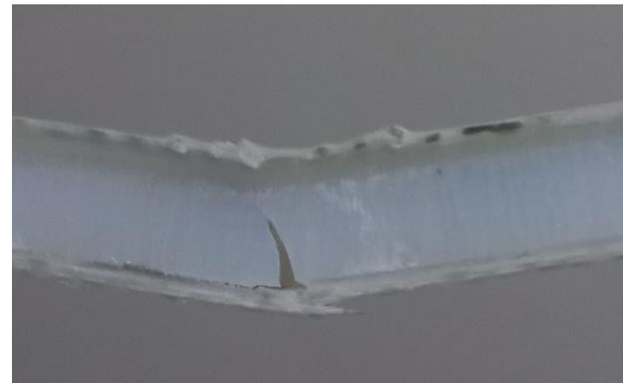
شکل ۴- نمونه سازه ساندویچی بعد از شکست.
