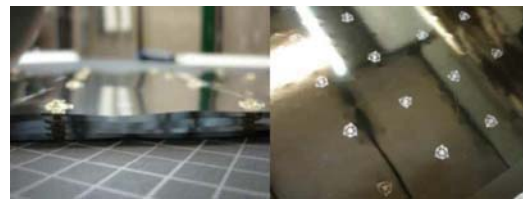
شکل (۴): عایق چندلایه یکپارچه با جداکننده‌های پلیمری [۱۷].
