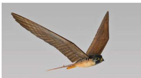
شکل (۴): ربات بال‌زن رویبرد ساخته شده شرکت هلندی با همکاری دانشگاه توتنه [۱۱].
