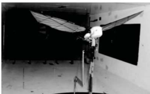
شکل (۵): تست بال زن سایبر پی ۲ در تونل باد [۱۳].
