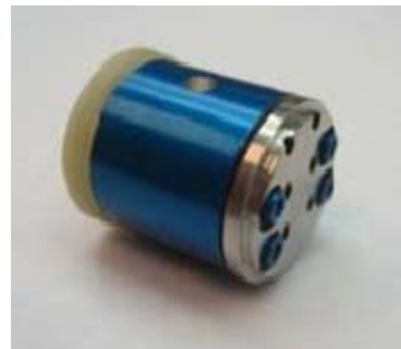
شکل ۴- سیستم میکروپیشرانس سوخت جامد دیجیتالی در فضاپیمای اسپینسات [۱۱]
