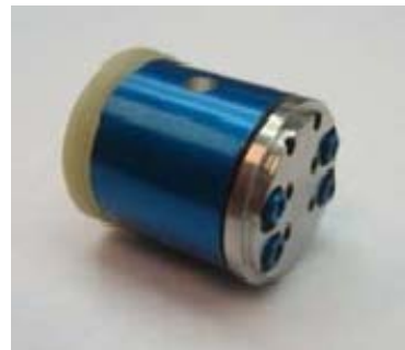
شکل ۴- سیستم میکروپیشرانش سوخت جامد دیجیتالی در فضاپیمای اسپینسات [۱۱]
