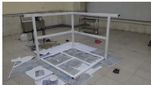
شکل (۳): اسکلت فلزی زیرساخت فضای استاندارد بعد از ساخت و پوشش توسط رنگ آمیزی.
