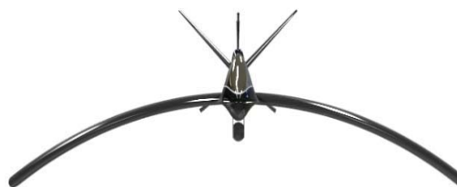
شکل (۱۶): تغییر شکل طول بال ناشی از خمش در پهپاد [۴۲].
