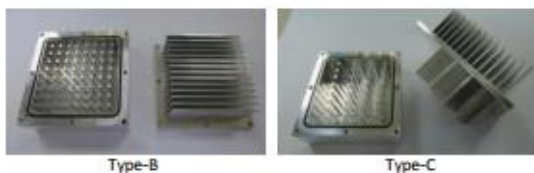
شکل (۱۲): سه نمونه از محفظه‌های حاوی مواد تغییر فاز دهنده در ماهواره FORMOSAT-5 [۱۶].
