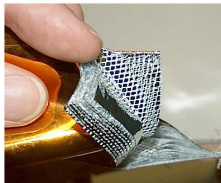
شکل (۶): نمونه‌ای از عایق‌های چندلایه ساخته شده برای استفاده در ماهواره [۱۰].
